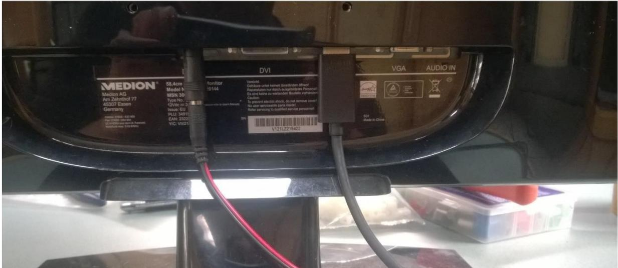
Das 12 Volt Stromkabel kommt in die DC Buchse und das HDMI Kabel natürlich in die HDMI Buchse. Kommt bei **SAT Empfang** nur ein **schwarzes Bild**, den **Monitor** vorne einmal **ausschalten** und nach einigen Sekunden **wieder einschalten**.
