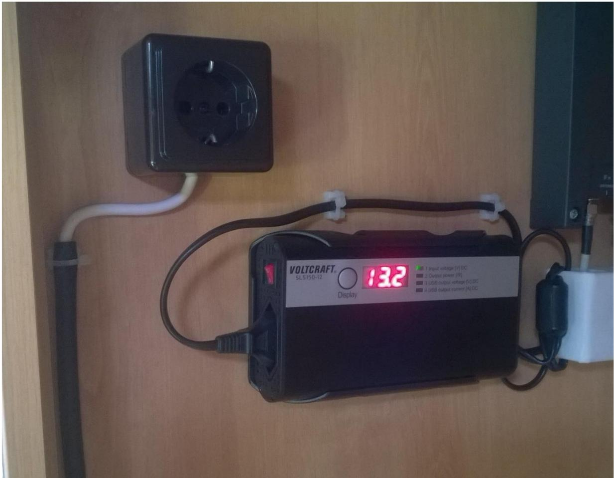
Wenn das Fahrzeug keine Verbindung zu Stromnetz hat, kann die Xbox One über einen Konverter aus der Board Batterie versorgt werden. Der Konverter stört die Fernbedienung des Sat Empfängers.
