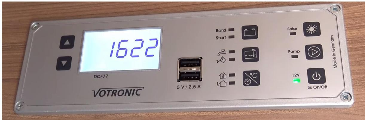
Beim ersten Druck auf die Taste für die Füllstandsanzeige der Wassertanks, wird der Füllstand des Frischwassertank in hundert Schritten von 0% bis 100% angezeigt.
